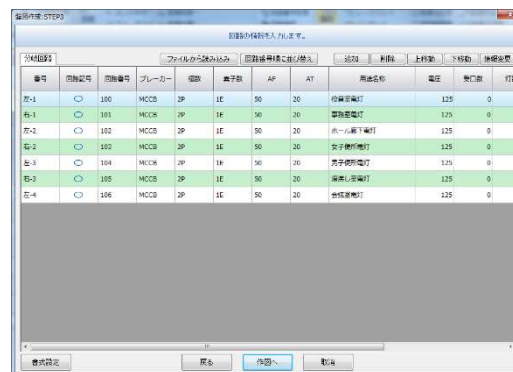
回路確認の機能で作成したファイルの分岐回路の情報がリストアップされます
